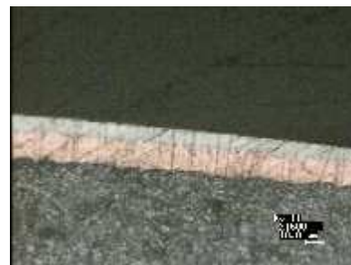
亜鉛素材上の銅・Niめっきの断面写真
