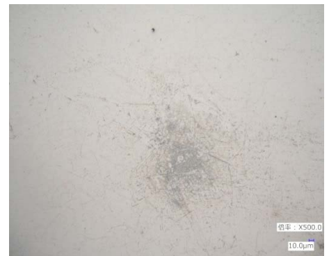
結露シミの拡大写真
